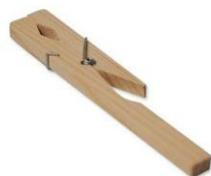
Pinza de madera para tubos de ensayo
