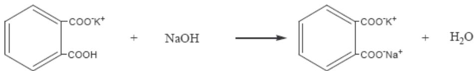
Preparar una solución de **hidróxido de sodio (NaOH) de concentración conocida no puede realizarse por pesada** ya que es **higroscópico**, además las **disoluciones de hidróxido sódico absorben dióxido de carbono y vapor de agua del aire**, por lo que se forma carbonato sódico y se diluyen. Por tanto, la **concentración inicial de NaOH varía con el tiempo**. Es por ello necesario preparar primero la disolución y posteriormente valorarla con un patrón primario.
